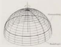
Bild 7.15: Kuppel mit Rippenstruktur
